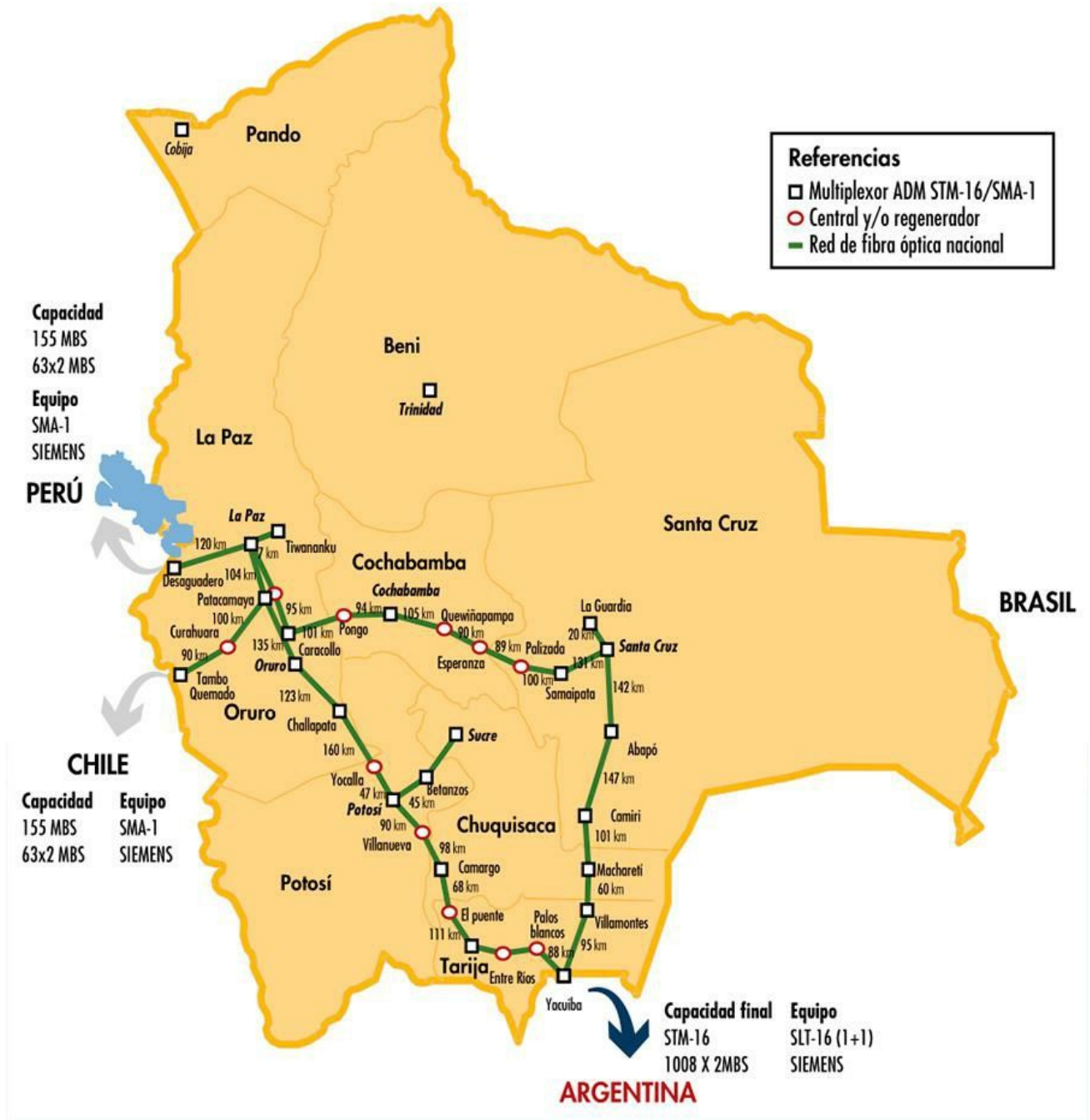
Figura 1.2.5 Red nacional de fibra óptica de Entel Fuente: Entel, Red nacional de fibra óptica, 2015.
